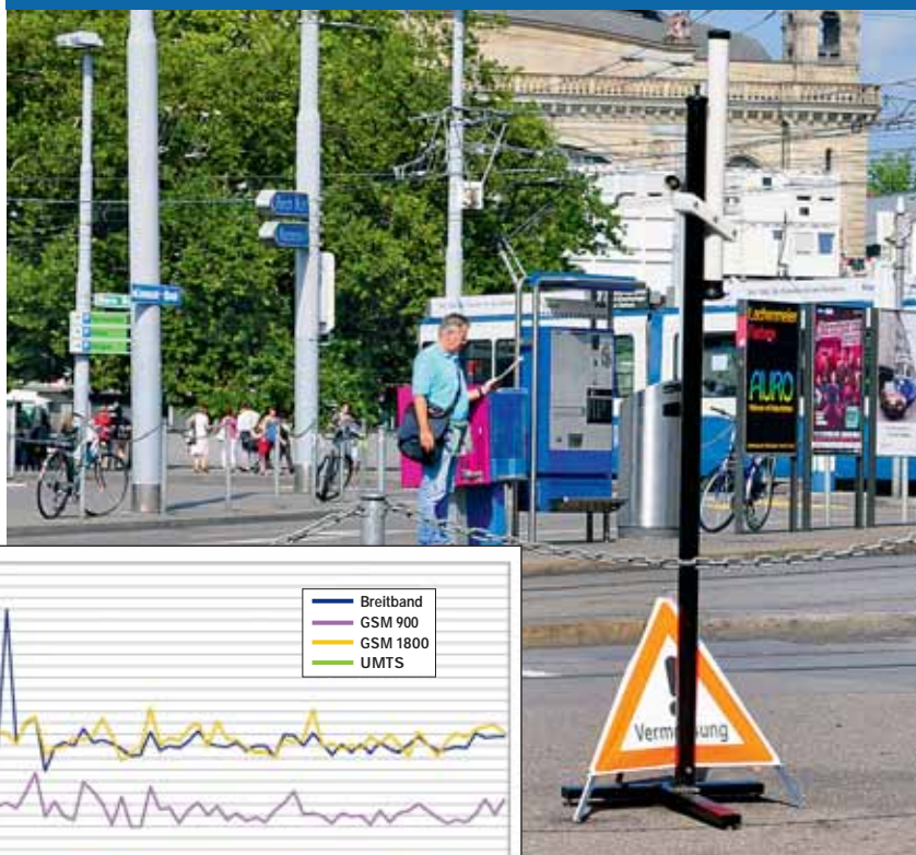
Hohe Werte für das GSM-1800-Mobilfunknetz, weil in unmittelbarer Nähe eine entsprechende Sendeanlage steht
