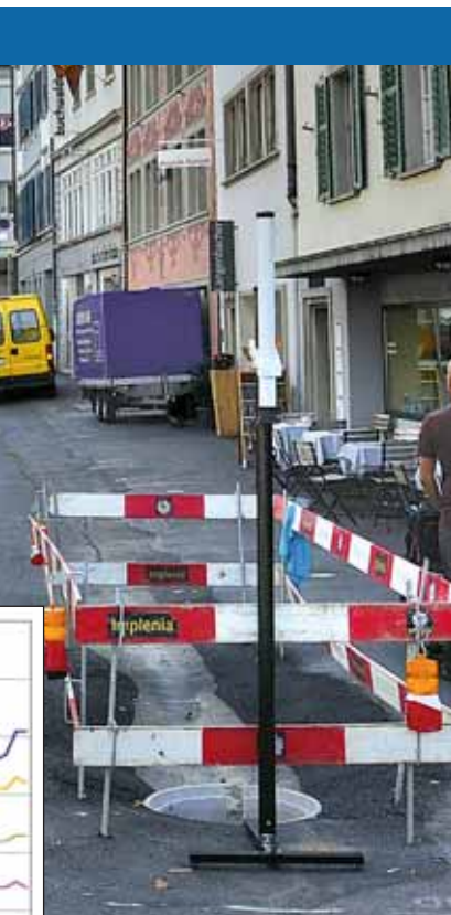
Vergleichsweise hohe Werte, weil direkte Sichtverbindung zu zwei Mobilfunk-Sendeanlagen besteht
