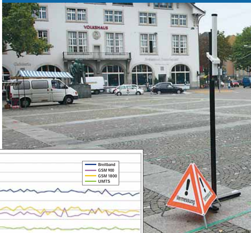
Tiefe UMTS-Werte, weil sich in der Nähe des Helvetiaplatzes keine entsprechende Sendeanlage befindet
